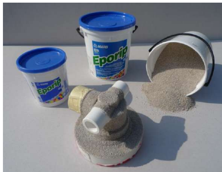
Superficie de PVC lijada, impregnada con Eporip y espolvoreada
