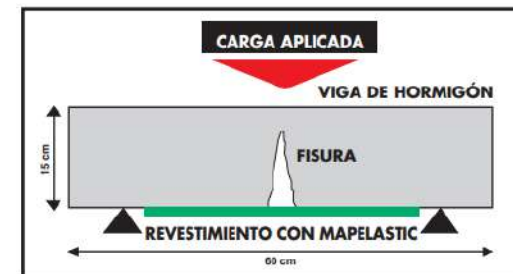
Fig. 1: Protección con Mapelastic de una fisura en el intradós de una viga de hormigón sometida a una tensión por flexión
