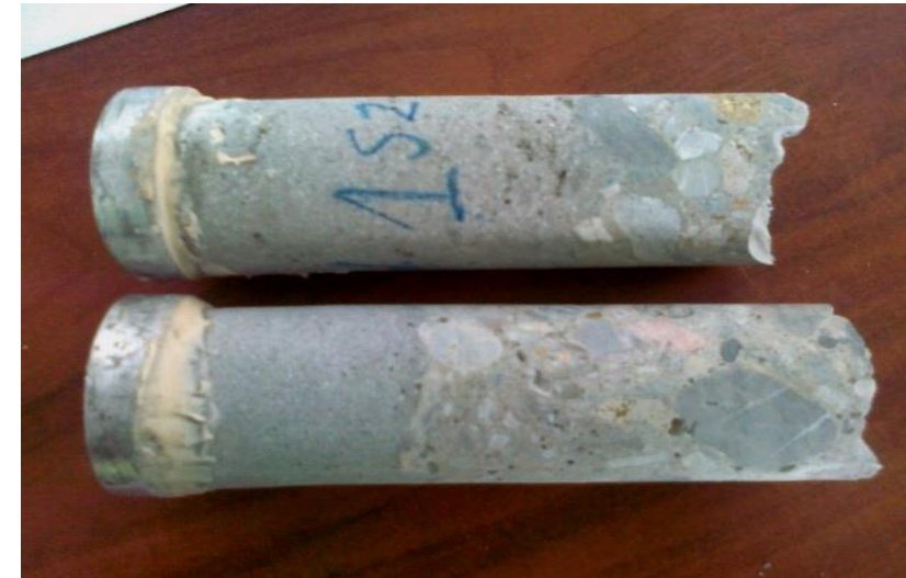
Testigos para ver la adherencia del mortero de reparación con el hormigón
